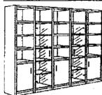
**Kombination 238,4 cm breit, 40,4 cm tief**, 3 Holztüren, 2 rahmenlose Glastüren, 8 Glas- und 12 Holz-Einlegeböden, 3 Zwischenböden, lichte Innenbreite 44,2 cm, offene Fächer ohne Rückwand
