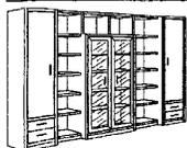
**Kombination 282,4 cm breit**, außen je 1 Holztür- 2 Schübe, 40,4 cm tief, je 4 Holz-Einlegeböden, lichte Breite 44,2 cm, Regalteile 32,9 cm tief, je 6 Fächer, lichte Breite 44,2 cm, **Mittelschrank 94 cm breit, 200,8 cm hoch, 40,4 cm tief**, 2 Alurahmen-Klarglastüren, 4 Glaseinlegeböden, lichte Innenbreite 88,2 cm, **Aufsatz 94 cm breit, 32,9 cm tief**, 2 Fächer, offene Fächer ohne Rückwand
